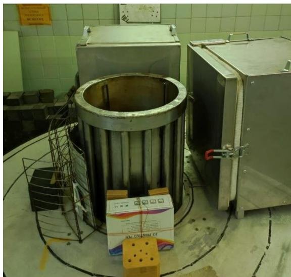
Рисунок 15 – Расположение термостатов относительно облучателя
