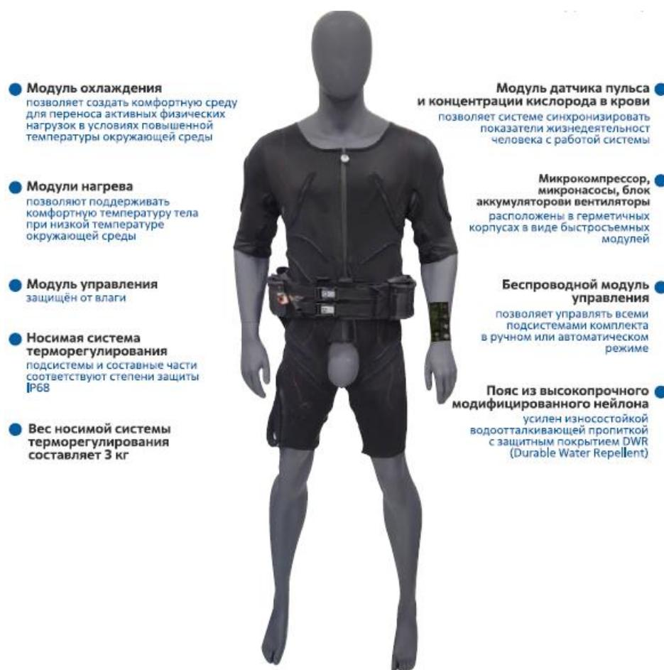
Рисунок 24 – Иллюстрация полнофункционального полноразмерного образца системы терморегулирования человеческого тела
