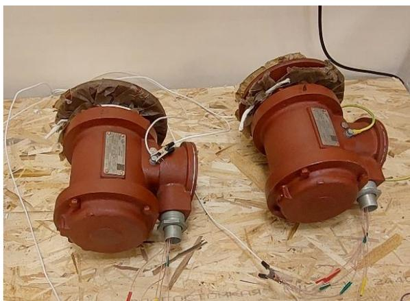
**Рисунок 12 – Электродвигатели марки 4AC71A4A5**
