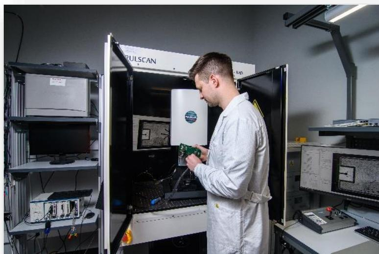
**Рисунок 3 – Фотография общего вида импульсной лазерной испытательной установки PULSYS-RAD, предназначенной для испытаний ЭКБ на стойкость к воздействию ТЗЧ**
