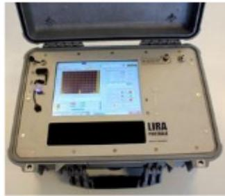
LIRA - компьютеризированный частотно-резонансный рефлектометр неоднородностей кабельных линий, основанный на измерении параметров стоячих волны, генерируемых в диапазоне от 25 кГц до 100 МГц с шагом от 5 кГц до 25 кГц. Изменение параметров стоячей волны свидетельствует о наличии в данной точке трассы неоднородности
