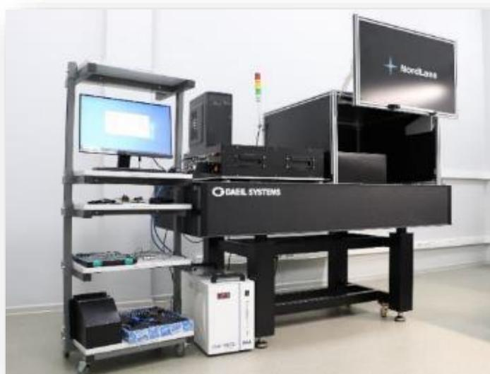
**Рисунок 4 – Фотография общего вида установки с перестраиваемой длительностью импульса лазерного излучения, предназначенной для испытаний ЭКБ на стойкость к импульсным ионизирующим излучениям по критерию мощности дозы**
