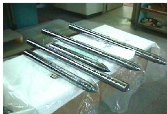
**Рисунок 19 - Фотографии, иллюстрирующие процесс выращивания слитков монокристаллического кремния методом БЗП**
